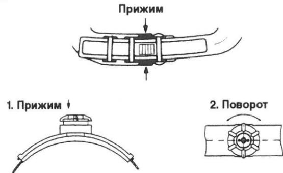
Правильная регулировка внутреннего оснащения обеспечивает оптимальную посадку каски.
